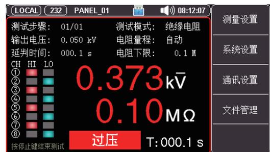
2、多种保护功能（过压保护、接地失效保护、短路保护）
