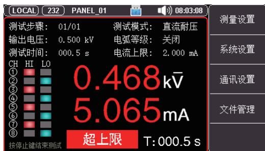
3、智能超限检测（电流上限检测、电流下限检测、电弧检测、充电下限检测）
